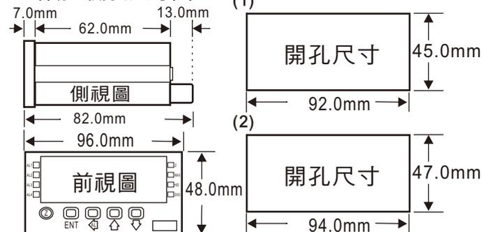
※註: 開孔尺寸(1)為標準尺寸,開孔尺寸(2)為附加防水罩
