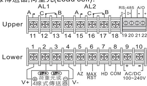
● 4線傳送器,荷重元(Load cell):
